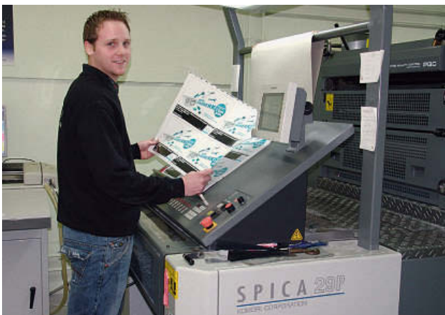
Florian Althoff, Offsetdrucker und Nachfolger in spe, ist begeistert von den kurzen Einrichtezeiten der Spica 529P. Der einfache Plattenwechsel erfolgt werkzeuglos per Präzisionsklemmschienen und auf Tastendruck.
