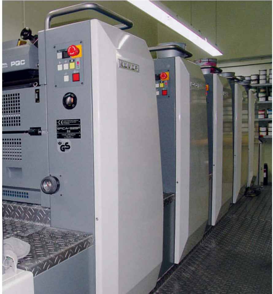
Mit einer Wendung nach dem zweiten Farbwerk ist die Spica 529P-Fünffarbenmaschine von Komori für alle anfallenden Aufgaben bei Althoff Druck gerüstet.
